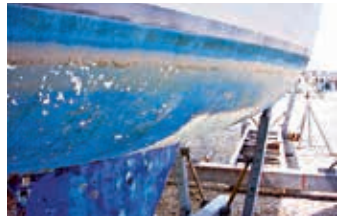
Burbujas y desprendimientos
