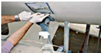
Lijado en húmedo para eliminar las capas antiguas de antiincrustantes.
