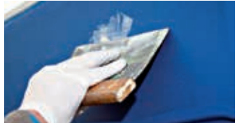
Appliquer le mastic avec une spatule
