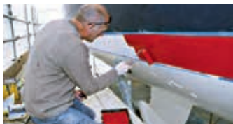
Peindre la ligne de flottaison
