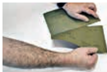
Ajuster le papier abrasif à la taille du bloc à poncer
